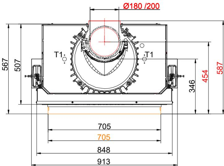
... Anbaurahmen und Wärmetauscherringe Guss + Gusskuppel
